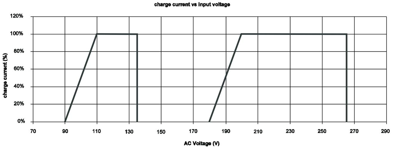
Abbildung 15: Ladestrom im Vergleich zu Eingangsspannung
