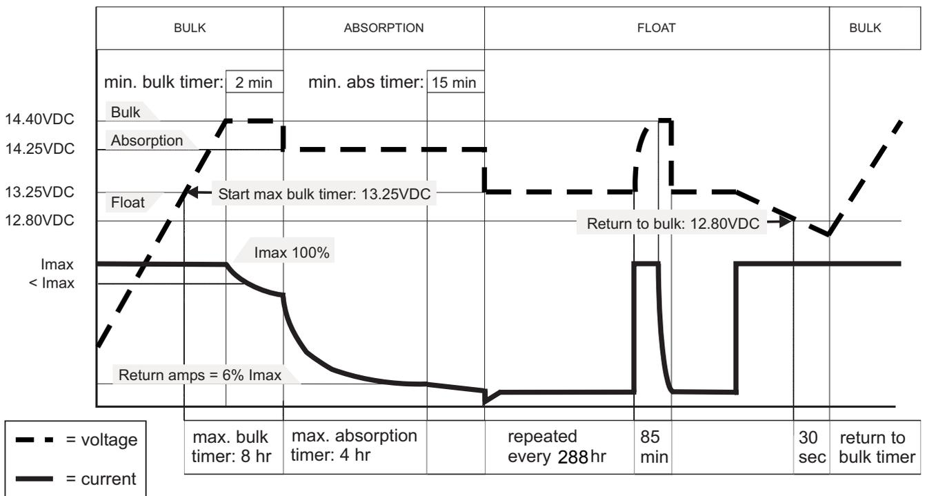
Abbildung 16: Ladekennlinie der Dreistufen-Plus-Lademethode (@ 25°C / 77°F)
