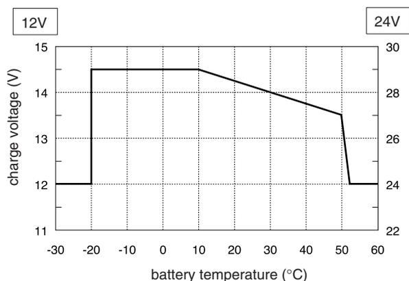
Abbildung 5: Laden mit Temperaturengleich
