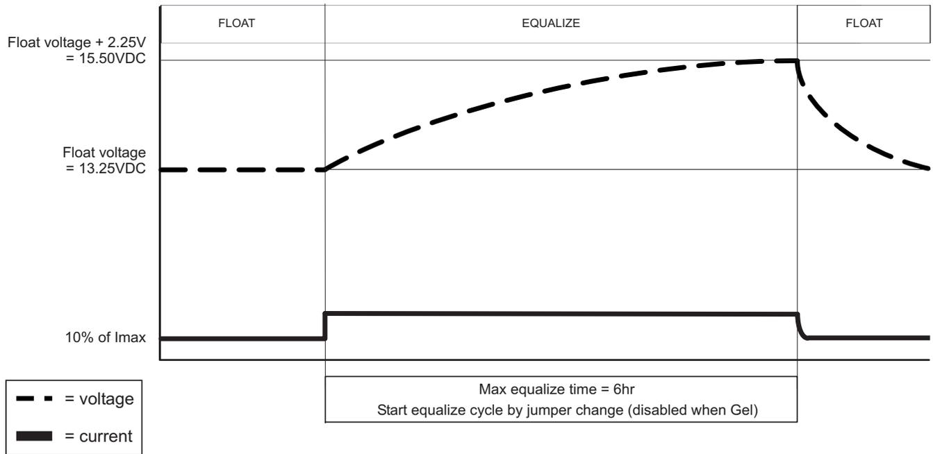
Abbildung 17: Ladekennlinie des "Zellladungsausgleichs"-Zyklus (siehe Abschnitt 5.1.1) (@ 25°C / 77°F)
