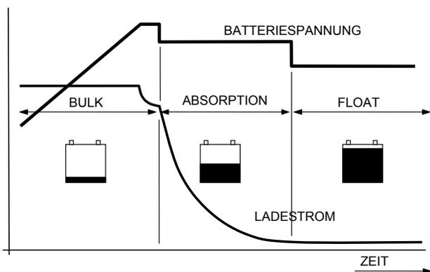
Abbildung 4: Dreistufen-Plus-Ladesystem
