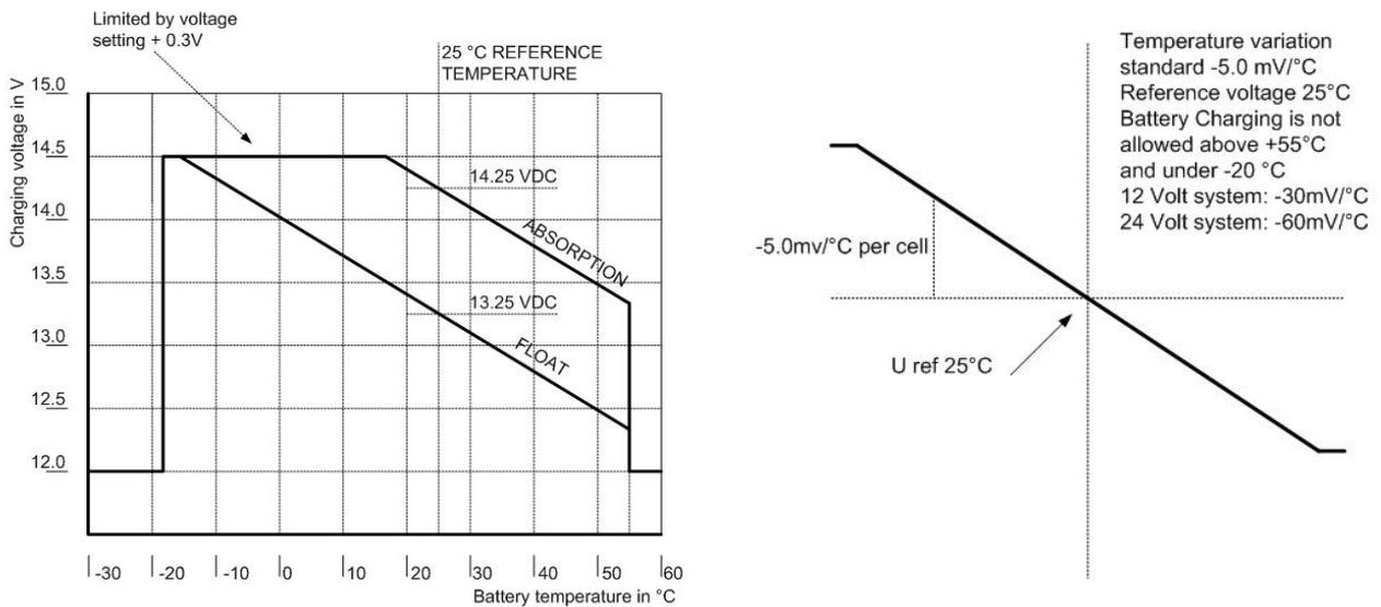
Abbildung 18: Kennlinie des Temperatursausgleichs (Ladespannung im Vergleich zur Temperatur)
