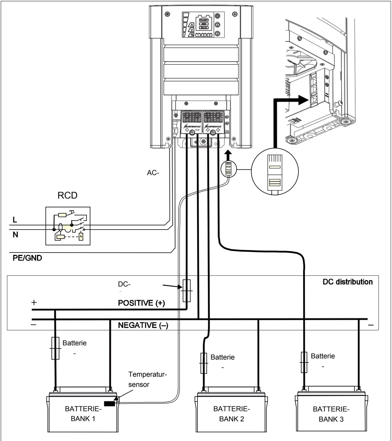
Anhand dieses Schemas soll die allgemeine Platzierung des Chargemaster in einem Kreislauf dargestellt werden. Es ist nicht als eine detaillierte Verkabelungsanleitung für jede einzelne Elektroinstallation gedacht.
