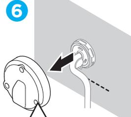
Die Abdeckung der Bordwanddurchführung entfernen
